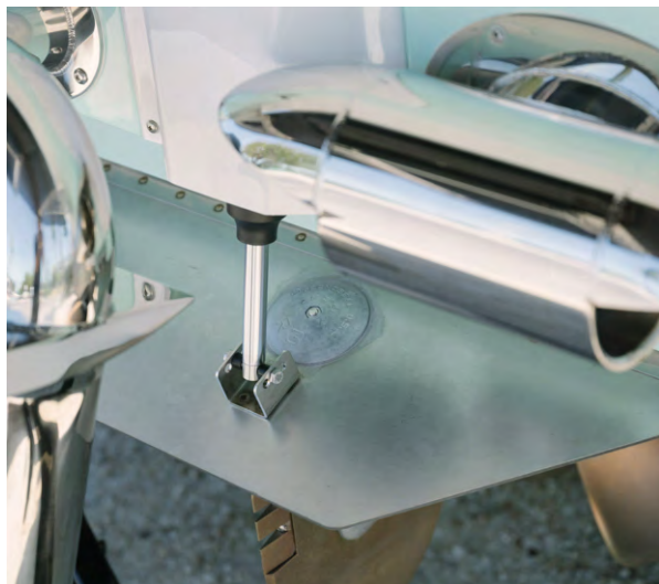
Anode Sacrificielle Soudée
